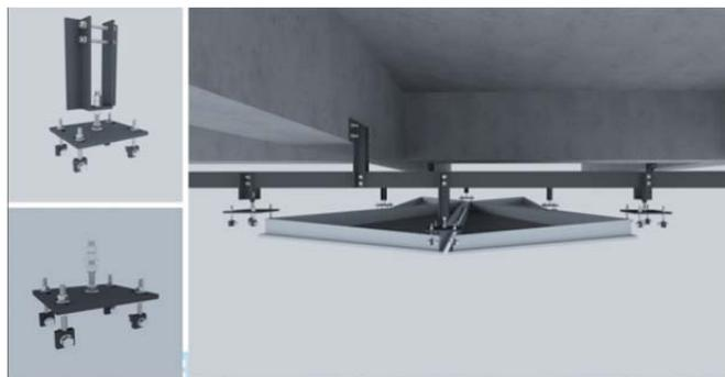
吊顶节点三维图
