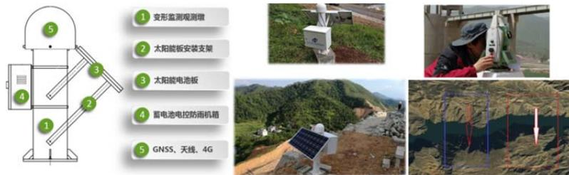
图 1 研发的全国产自主可控的高精度位移监测终端
