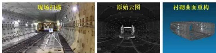
图4 地下工程施工全断面三维扫描监测技术
