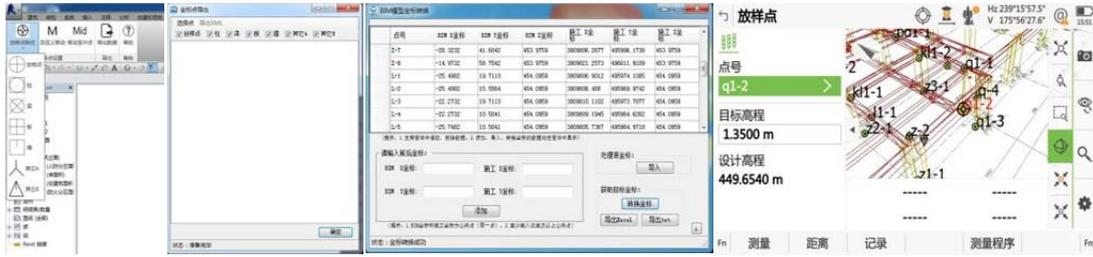
图 2 BIM 模型坐标分类读取、导出、坐标系转换和三维可视化放样
