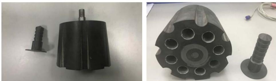
图 1 护盾式 TBM 仰拱支撑组件成品
