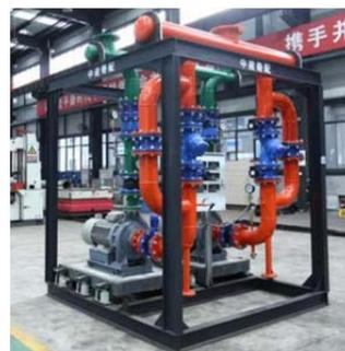
图2 标准参数化泵组模块
