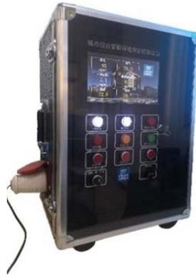
该装置可实现六大参数的实时监测，主动采样、自动分析，测量浓度直接在显示屏上显示。可以设定报警值，环境参数检测达到报警阈值时会自动发出声光报警信号；并可以自动启动风机或降尘器，进行机械强制排风或喷雾降尘等措施，改善环境危险因素，保证施工人员安全，总的来说，该设备具有如下五大特点：
