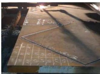
1、钢结构智能套料、材料管理技术：将深化模型录入智能套料软件，使用超级算法算出最佳排版方式，将板材利用率最大化。以上智能建造技术达到了建筑过程的自动化、数字化、网络化、可视化。融合了优势的资源，极大提升了企业运营效率。
