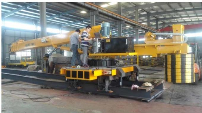
(2) 首创自行式桥面吊机吊装施工技术：利用已成形的桥段作为构件运输平台，其上铺设轨道，桥面吊机在轨道上开行及吊装作业，再以行走小车作为构件运输设备，依次向前逐段安装景观步道钢结构；
