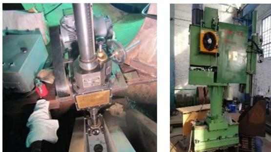
图2：压力容器支撑高精度沉头盲孔制作和钻镗一体机
