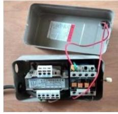
手动停止复位器内部结构图
