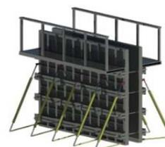
管廊中墙加固一体化模板主要为大钢模和三角支撑组成，利用管廊中墙标准构件的特点，大钢模尺寸根据管廊中墙尺寸确定，大钢模两侧附着有人行走道架，便于工人施工时行走；大钢模通过两侧的三角斜撑固定；大钢模下部设有滑动装置，便于工人拆装，周转用于下一施工段。
