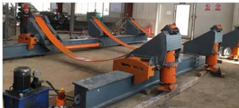
创新点 3. 设计了高度补偿结构，使各支座受力均衡，具有整体自稳性。
