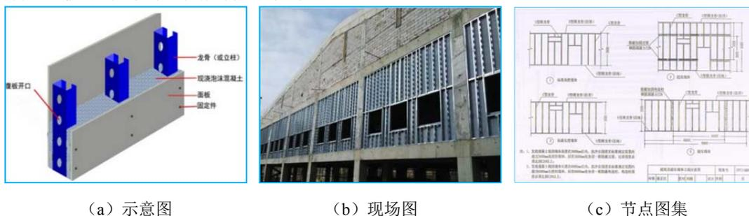
图8 轻钢-轻混组合结构墙体
