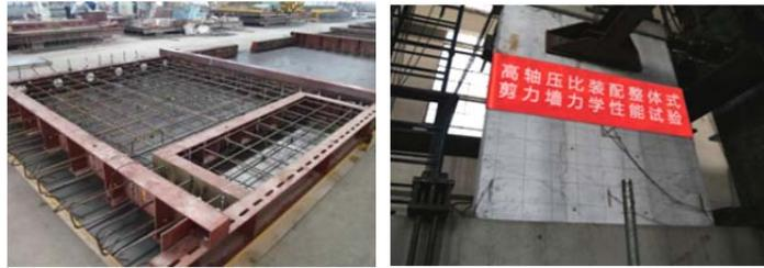
图2 剪力墙结构墙体竖向连接结构抗震性能试验和施工应用
