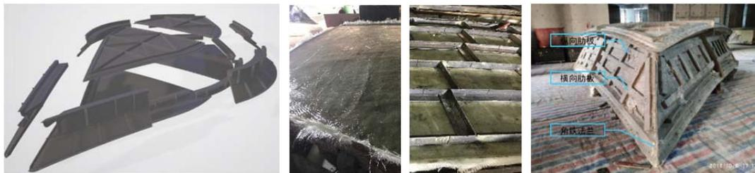
图 8-a 模具分块设计示意
