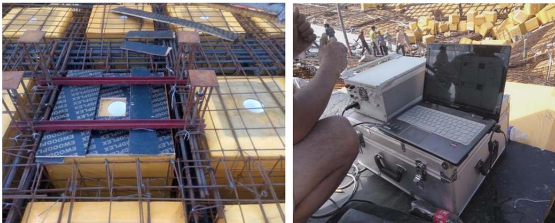
图1 芯模上浮力测试装置与方法
