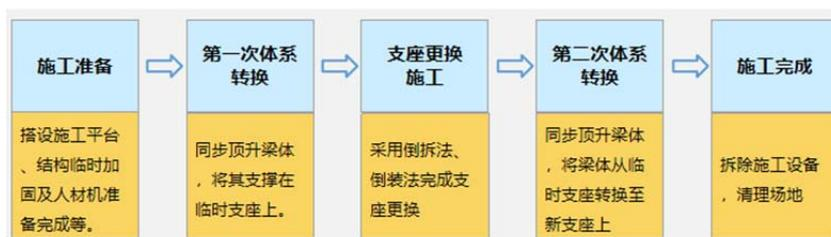
第二次体系转换，同步顶升梁体，将梁体从临时支座转换至新支座上。
