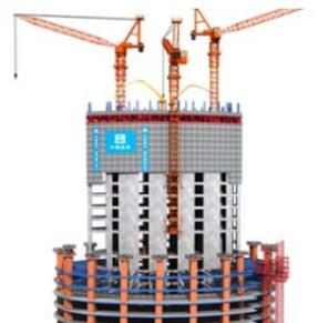
图 2 外挂架增设覆盖一个楼层的挂架
