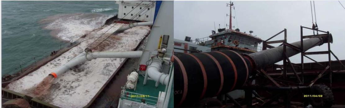
该技术明显缩短泥驳靠离驳的辅助时间，提高自航绞吸船开挖风化岩时运转时利率，船舶平均时利率达 65%；避免装驳期间航道内直接溢流情况，有效改善施工质量，绞吸开挖实现一次成槽，平均超深在 0.35m 以内；与固定装驳平台相比，减少大量的移接管线的的时间，实现抓斗装驳平台、配套泥驳、浮筒管线与施工主船（挖岩绞吸船）同步移动；减少航道内通航水域占用宽度，平均每日减少避让次数 2 次，节约避让时间，安全风险降低。与直接装驳工艺相比，减少船舶占用期，同时保证较低综合成本。该成果获授权实用新型专利 5 项，发表论文 1 篇，水运工程一级工法，国家二级工法，水运科学技术进步三等奖。经知经中国水运建设行业协会鉴定：该成果总体达到了国际先进水平。
