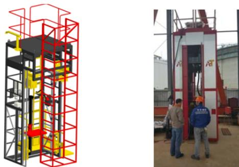
图2 大型储罐自动焊辅助工作仓
